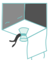
Auslauf mit Bodenklappe
