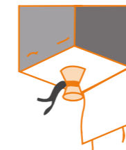
Auslauf mit Bodenklappe
